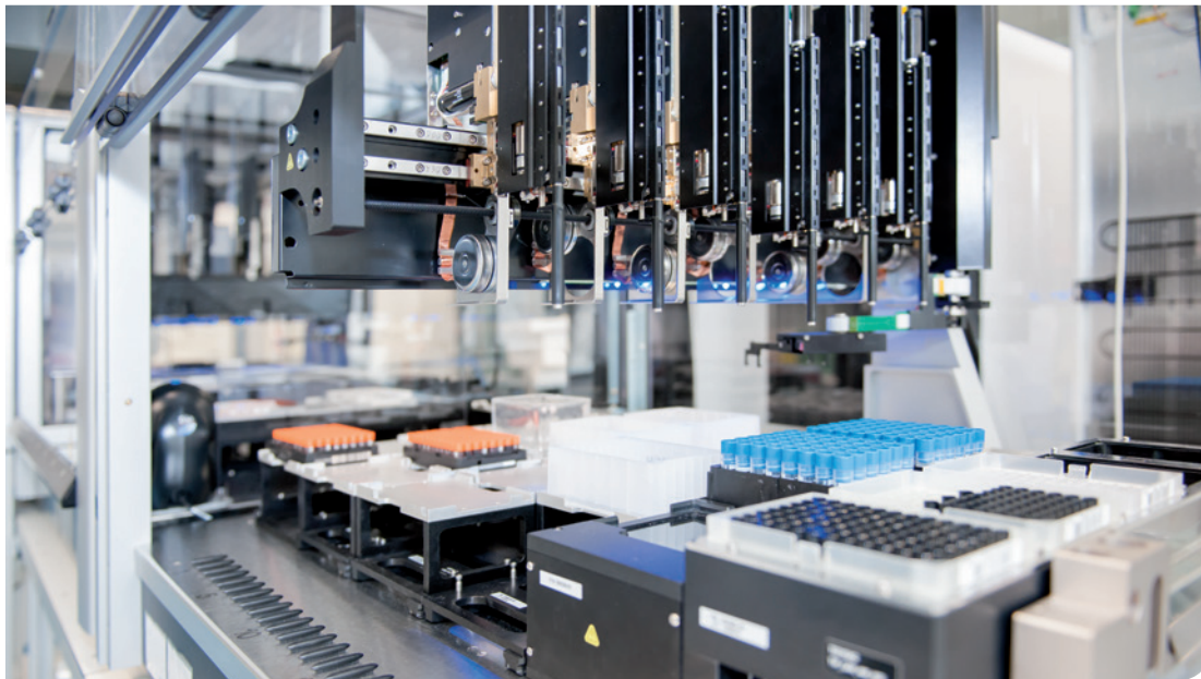
Auf der Suche nach neuen Biomarkern zur Diagnose von Prostatakrebs nutzt das Fraunhofer IZI Pipettierroboter, die RNA aus Gewebeprobe isolieren. © Fraunhofer IZI
