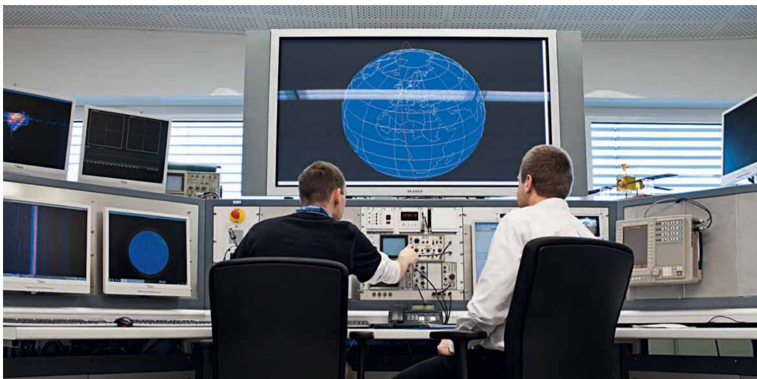
Fliegt ROSAT noch auf der vorausberechneten Bahn um den Globus? Im Kontrollraum des Fraunhofer FHR wird die Radaranlage TIRA gesteuert, die den Weg des Satelliten am Himmel verfolgt. © alle Fotos Michael Pasternack
